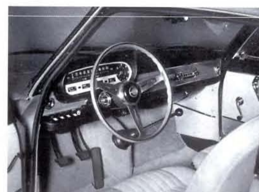
A sinistra, la Lancia Flavia Coupé 1.8 a iniezione in una curiosa foto ufficiale dell'epoca. Sotto, il cruscotto di una Lancia Flavia Coupé preserie con il volante Nardi che per la produzione sarà sostituito da un altro di forma più coerente con lo stile Lancia.
