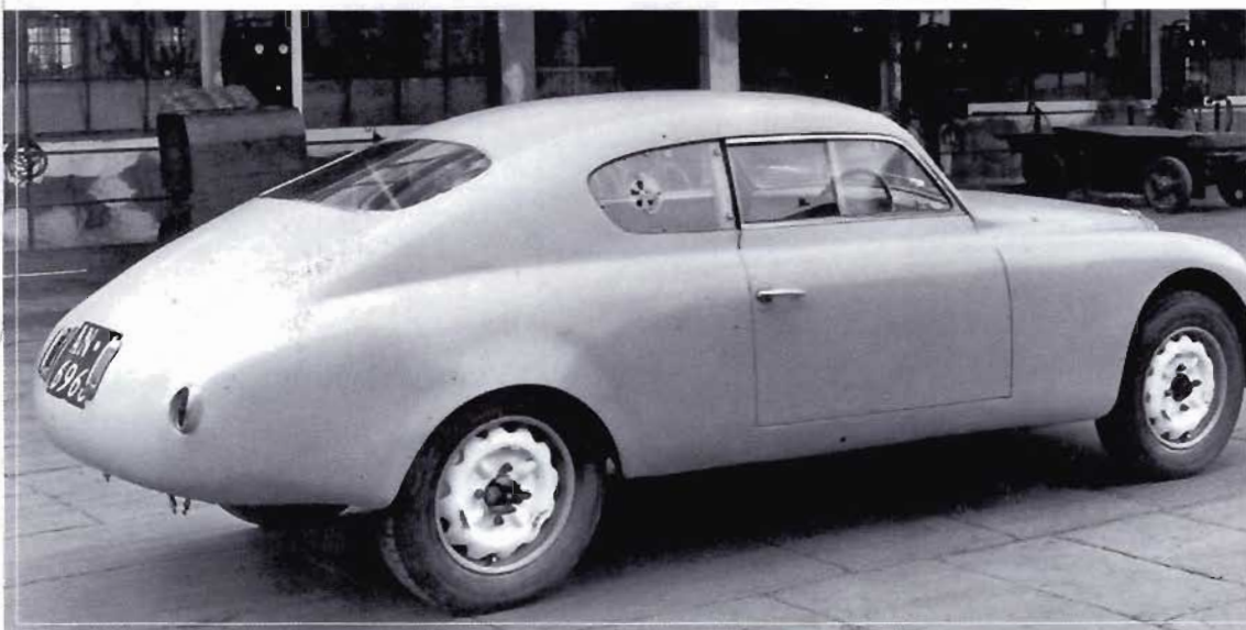
Sopra, la Lancia Aurelia GT B20 di Luigi Fagioli pronta per la consegna. La carrozzeria in alluminio è priva del coperchio del baule, una caratteristica di tutte le B20 da corsa della seconda serie. Sotto, 9 marzo 1952. La B20 di Enrico Anselmi e Luciano Gianni a un controllo del Giro di Sicilia. In primo piano (con un foglio in mano) Giuseppe Gillo, responsabile della messa a punto dei motori.
