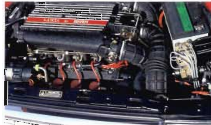
Sopra, il motore a otto cilindri trentadue valvole della Lancia Thema 8.32 studiato e realizzato dalla Ferrari sviluppava 215 cv ed era in grado di spingere la vettura a 240 km/h.
