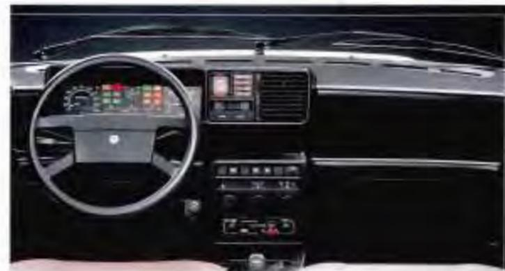
*Sopra, la Lancia Prisma in un'immagine che esalta la classica bellezza della forma a tre volumi. A sinistra, il cruscotto della Lancia Prisma diesel riconoscibile dalla spia delle candele di preriscaldamento. A parte questo particolare la plancia è comune agli altri modelli.*
