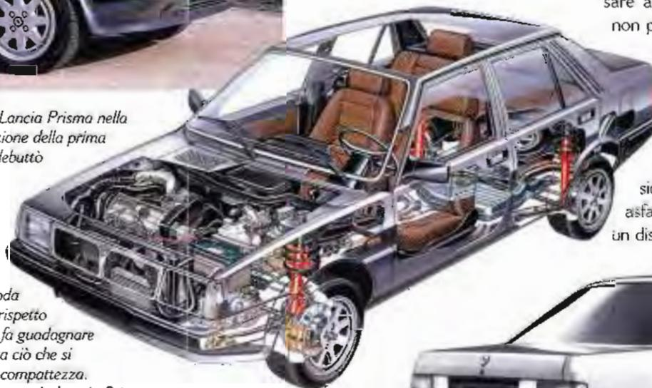
*Sopra, trasparenza della Lancia Prisma a due ruote motrici.*
