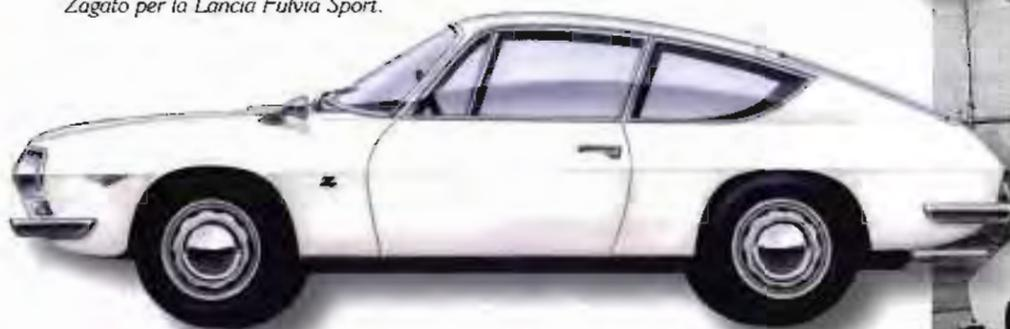
Nel novembre 1965 la Lancia Fulvia Sport allargò la gamma delle Fulvia estremizzando i concetti della Coupé con una carrozzeria in alluminio e due posti secchi. Il design e lo sviluppo del modello furono affidati a Zagato con la richiesta di una costruzione leggera e profilata che utilizzasse senza modifiche il pianale della Fulvia Coupé con il motore di 1216 cc con 79 cv. Ercole Spada, lo stilista che con Elio Zagato prese in
