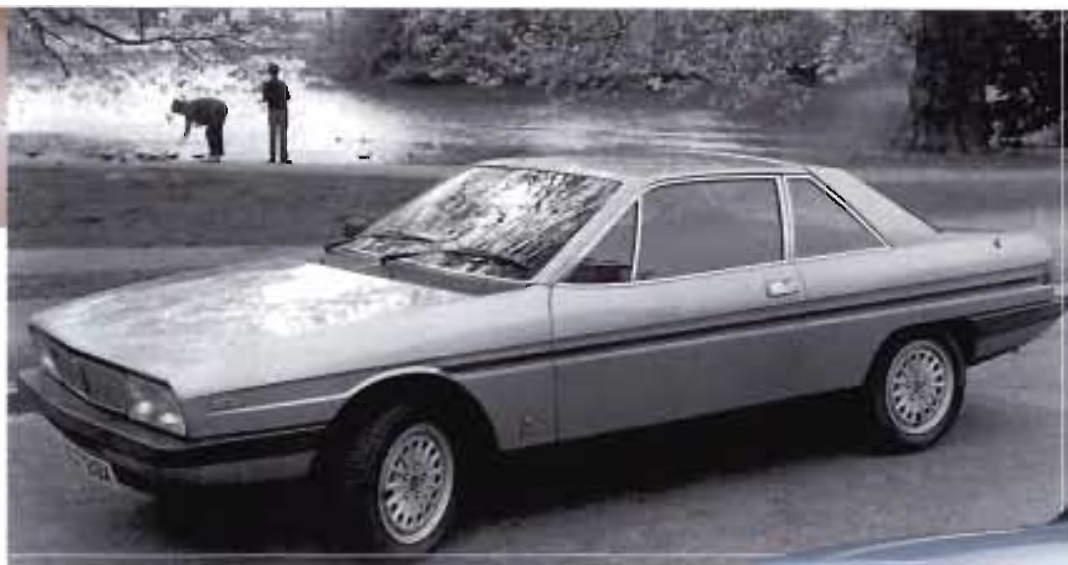
A sinistra, una Lancia Gamma Coupé FL2 seconda serie nella versione per il mercato inglese, riconoscibile dallo specchio retrovisore e dalle racchette dei tergicristalli a destra. Sotto, la Lancia Gamma Coupé seconda serie. Si notano la nuova calandra e i cerchi in lega di nuovo disegno. Altre piccole modifiche riguardarono alcuni dettagli minori.
