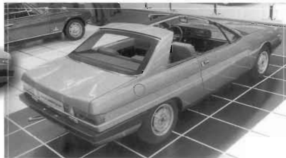
Sotto, a sinistra, la parte posteriore della Lancia Gamma Coupé 2500 prima serie era del tutto identica a quella della versione 2000, tranne che nella scritta. Sotto, la Lancia Gamma Coupé 2000 Spider - T. Roof -, un bel prototipo del 1978 che nella parte inferiore utilizzava l'impianto stilistico della Coupé di serie.
