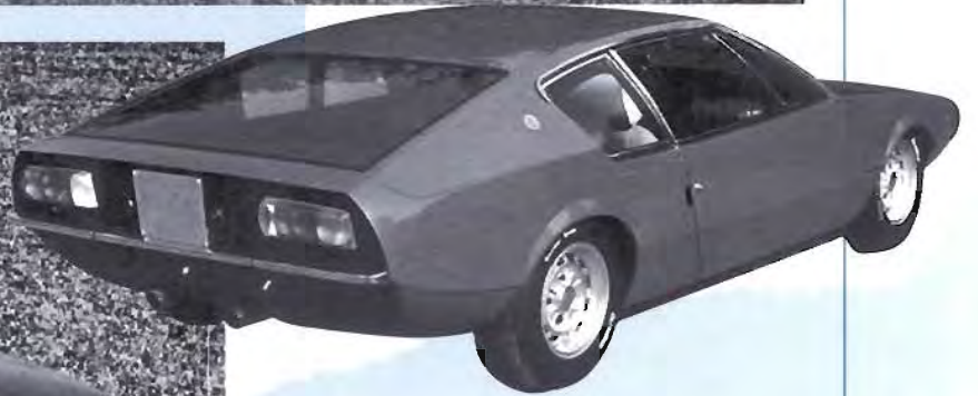
In alto, la forma bassa e allungata della Synthesis risalta particolarmente nella vista di lato. Sopra, la Synthesis vista di tre quarti posteriore. La coda è tronca, i montanti sono ampi, il lunotto è fisso per evitare complicazioni costruttive. A sinistra, la Synthesis vista di tre quarti anteriore. Il muso affilato è dotato di fari a scomparsa.
