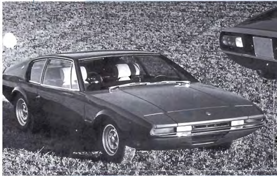
In alto, la forma bassa e allungata della Synthesis risalta particolarmente nella vista di lato. Sopra, la Synthesis vista di tre quarti posteriore. La coda è tronca, i montanti sono ampi, il lunotto è fisso per evitare complicazioni costruttive. A sinistra, la Synthesis vista di tre quarti anteriore. Il muso affilato è dotato di fari a scomparsa.
