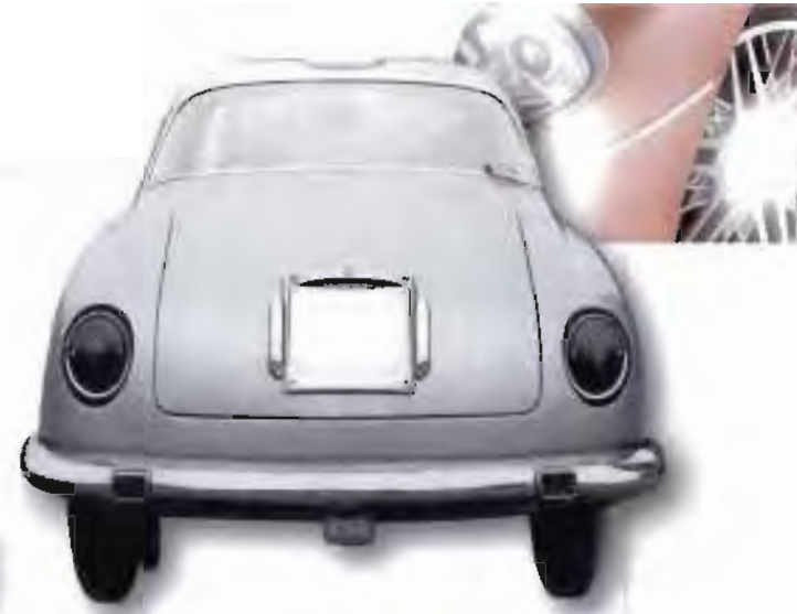
Sopra, la coda della Lancia Flaminia Sport aggiornata al Nuovo Codice della Strada: gli indicatori di direzione sono color arancio. Si notano inoltre le gemme catarifrangenti e il faro della retromarcia bianco.
