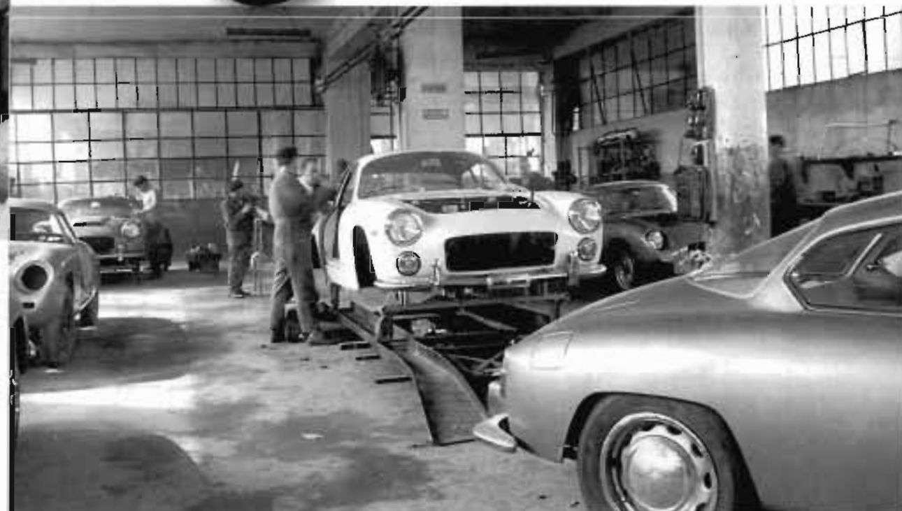
La prima Lancia Flaminia Sport con i fari non carenati, ma ancora priva dei ripetitori laterali degli indicatori di direzione.
