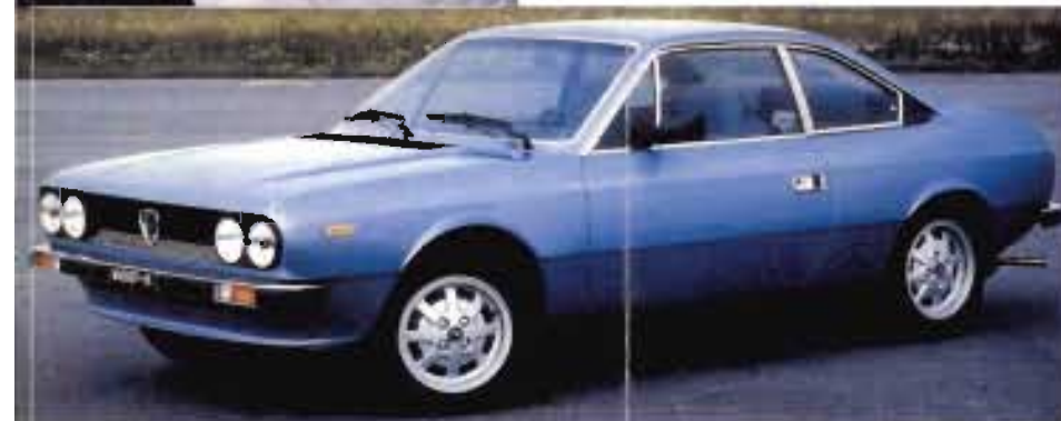
Sotto, la versione VX dotata di compressore volumetrico. La si riconosceva all'esterno dallo spoiler sotto il paraurti e dai rigonfiamenti sul cofano.
