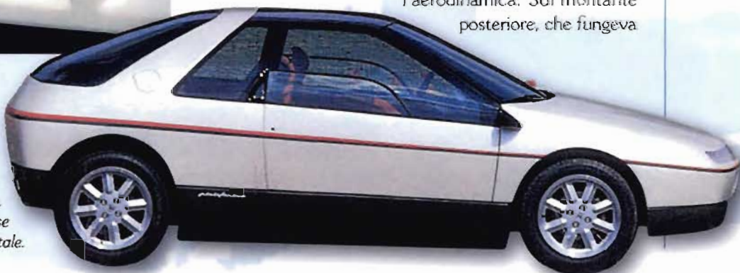
A destra, nella vista laterale risaltano la linea a uovo, il lunotto a cupola e il roll bar evidenziato dalla parte superiore del tetto lasciata nel nero naturale.
