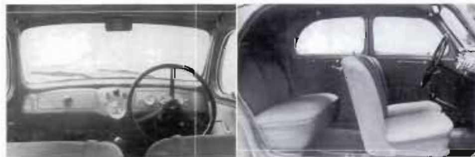
Sotto, gli interni della Lancia Ardea II Serie. Si notano i fondi degli strumenti bianchi che nella I Serie erano neri. Le porte si aprivano ad armadio.
