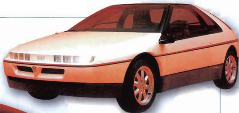
A destra, la Lancia Hit vista di tre quarti anteriore. Si nota la globale rotondità delle linee. Sotto, la Lancia Hit vista di tre quarti posteriore. I fanali sono integrati nei profili colorati che corrono attorno al corpo vettura.
