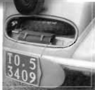
Sopra, il vano per la ruota di scorta. La foto si riferisce a un esemplare preserie diverso per il fanaletto sopra la targa.
