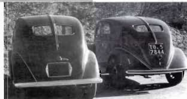
A sinistra e sotto, una Ardea e una Aprilia a confronto. Si somigliano, ma la calandra che nella Ardea è incastonata nell'Aprilia è sovrapposta. Differenti pure il boule e le dimensioni.
