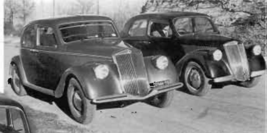
A sinistra e sotto, una Ardea e una Aprilia a confronto. Si somigliano, ma la calandra che nella Ardea è incastonata nell'Aprilia è sovrapposta. Differenti pure il boule e le dimensioni.
