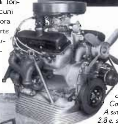
Sopra, una Lancia Flaminia 2.8 esposta al salone di Francoforte nel 1963, anno in cui fu introdotta la versione 2.8 con la cilindrata del motore portata a 2775 cc. Con 129 cv poteva raggiungere 170 km/h. Sotto, a sinistra, il materassino offerto come accessorio della Casa per la Lancia Flaminia 2.8. A sinistra, il motore della Flaminia 2.8 e, sotto, il volante.
