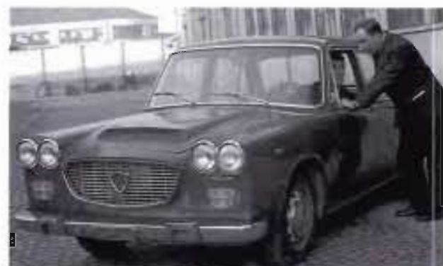
A sinistra, la Lancia Flavia con il passo accorciato che servì per sperimentare la meccanica della Fulvia. La protuberanza sul cofano doveva contenere il maggiore ingombro del motore. A destra, il prototipo somigliante alla Lancia Appia.
