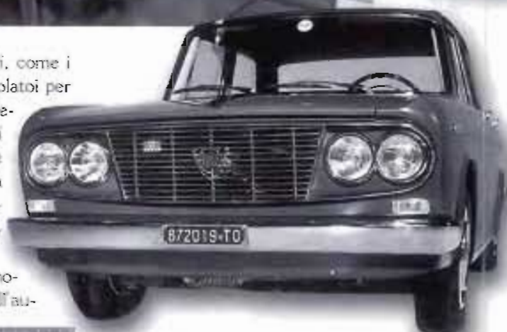
Sopra, a destra, la Lancia Fulvia GT vista di tre quarti anteriore. A parte le scritte identificative, la carrozzeria è identica a quella della 2C. Nella meccanica cambia la cilindrata: 1231 cc che garantiscono 80 cv. Sopra, la Lancia Fulvia GT vista di fronte. Qualche tempo dopo il lancio il modello fu disponibile anche con il comando del cambio a cloche sul pavimento.
