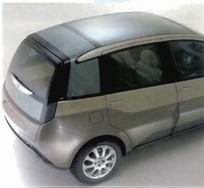
A destra, un'unica superficie trasparente raggruppa il lunotto, i fanali, le luci di retromarcia e il logo del modello, senza interrompere la continuità delle trasparenze del tetto.
