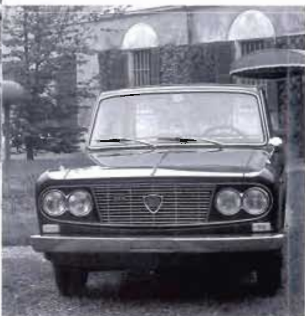
Sopra, a destra, la Lancia Fulvia GT vista di tre quarti anteriore. A parte le scritte identificative, la carrozzeria è identica a quella della 2C. Nella meccanica cambia la cilindrata: 1231 cc che garantiscono 80 cv. Sopra, la Lancia Fulvia GT vista di fronte. Qualche tempo dopo il lancio il modello fu disponibile anche con il comando del cambio a cloche sul pavimento.
