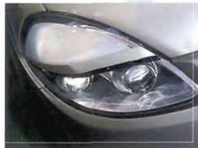
Sotto, particolare del faretto anteriore. All'interno delle calotte trasparenti i "cannoncini" sono disposti sotto una palpebra di lucentezza metallica.
