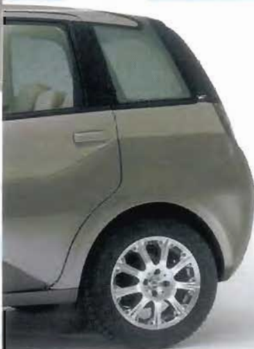
A sinistra, l'immagine evidenzia la continuità della superficie trasparente sul tetto, sul lunotto e sulle "spalle" del padiglione. A fianco, la coda con la protezione laterale in plastica, il finestrino mascherato e gli pneumatici adatti al fuoristrada leggero.
