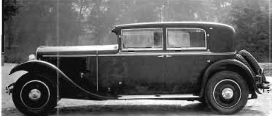
A sinistra, una luminosa berlina Weymann carrozzata nel 1931 dall'inglese Mulliner, noto specialista degli autotelai Rolls Royce. Sopra, una svelta berlina carrozzata nel 1932 dagli Stabilimenti Farina. Nella coda si notano le due ruote di scorta poste in posizione inclinata.
