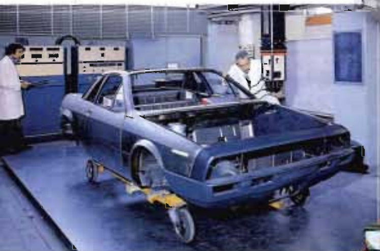
Sotto, la scocca della Lancia Beta Montecarlo durante i rilievi con speciali attrezzature nelle ultime fasi della realizzazione del prototipo. A destra, la Lancia Beta Montecarlo Spider nella prima versione con le "pinne" interamente metalliche.
