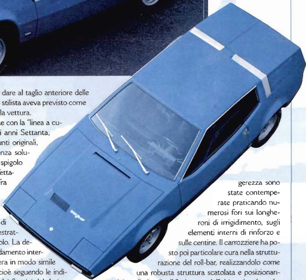
A sinistra, nella parte posteriore si notano il cofano bagagli in continuità con il tetto e il lunotto perfettamente verticale. Sotto, la Lancia Dunja vista dall'alto.
