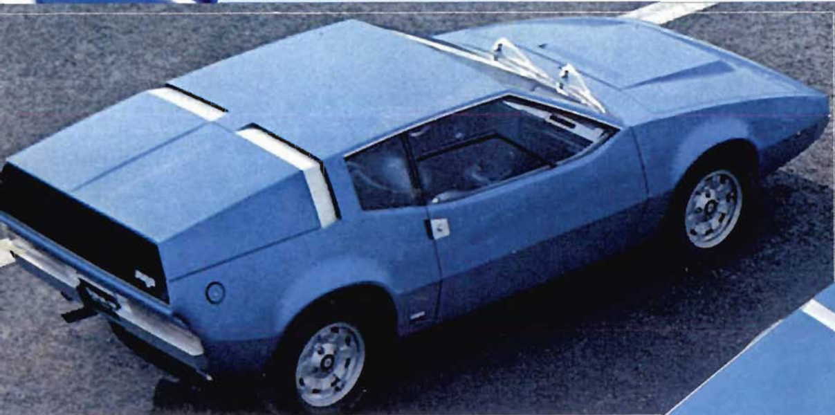
A sinistra, nella parte posteriore si notano il cofano bagagli in continuità con il tetto e il lunotto perfettamente verticale. Sotto, la Lancia Dunja vista dall'alto.
