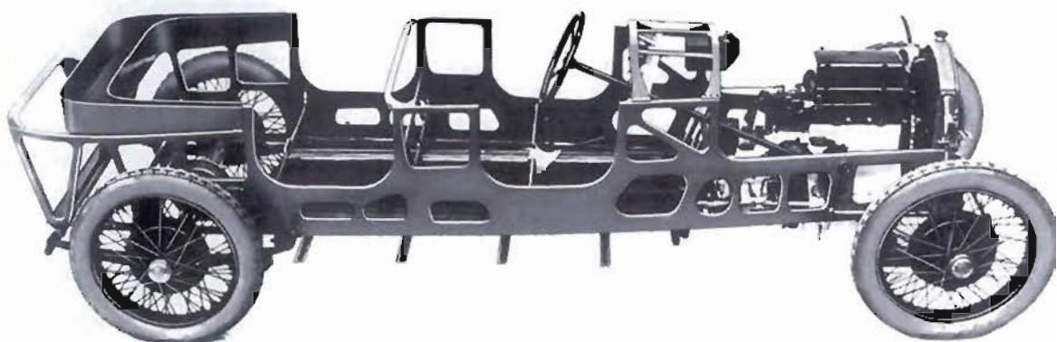
*Sopra, il modernissimo autotelaio della Lancia Lambda nel quale per la prima volta il telaio vero e proprio fu integrato nella scocca, che in questo modo diventò portante. Sotto, un figurino della Lancia relativo all'ipotesi di una carrozzeria "balloon", in altre parole di una torpedo (aperta) trasformabile in guida interna (chiusa) mediante l'aggiunta di un tetto amovibile.*
