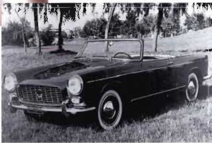
Sopra, la Lancia Appia Convertibile nella seconda versione era dotata di due posti di fortuna posteriori, di una presa d'aria sul cofano e di parafranghi posteriori rettilinei senza insellatura.
