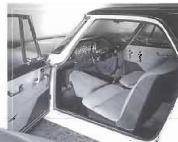
Sopra, il posto di guida della Appia Coupé. Sulla plancia realizzata in alluminio e verniciata in nero raggrinzante sono allineati tre strumenti. La leva del cambio è sul pavimento, non al volante come nella berlina.
