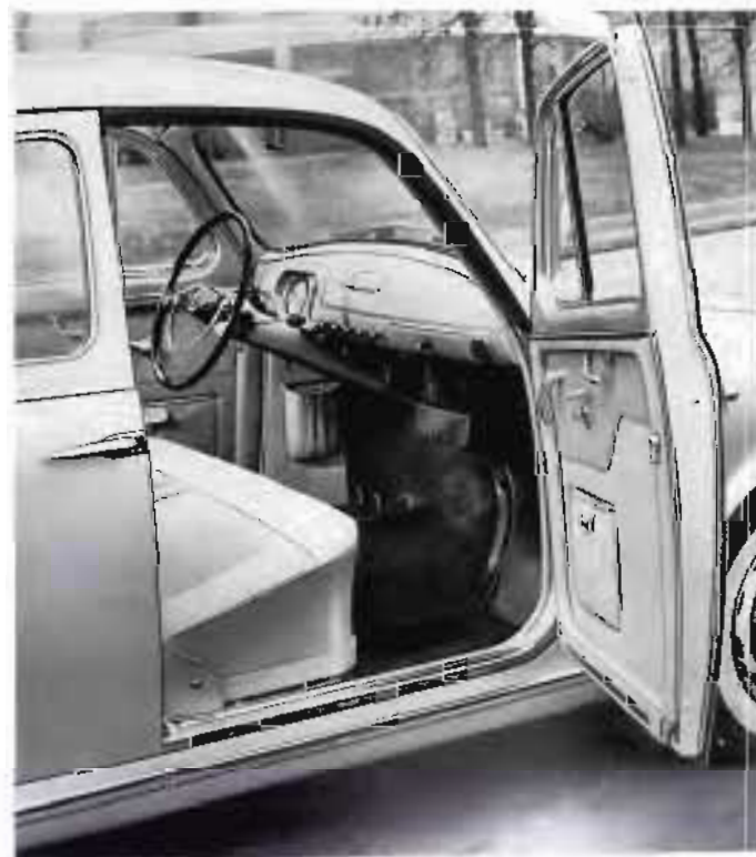
A sinistra, l'interno realizzato con la cura consueta di tutte le Lancia. Rispetto alla II Serie si notano i rivestimenti delle porte incassati di 2 centimetri per parte allo scopo di aumentare l'abitabilità nel senso della larghezza.
