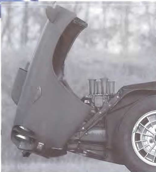
Sopra, il motore della Flavia Sport Prototipo 1800. Si notano i lunghi tromboncini di aspirazione che costrinsero a realizzare le bugne sul cofano per contenerli. A sinistra, il grande, ma leggero cofano ad apertura integrale della Flavia Sport Prototipo 1800. Quello della 2000 era pressoché uguale. Sotto, la Lancia Flavia Sport Prototipo 2000 mentre si reca alle verifiche tecniche prima della Targa Florio. Sul muso si nota la calandra che per la gara verrà eliminata allo scopo di migliorare il raffreddamento.
