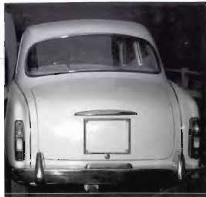
Sopra, nella Lancia Appia III Serie, rispetto alla II Serie cambiano i fanali, le creste dei parafranghi, il paraurti e la luce della targa. Il fregio cromato che funge da maniglia d'apertura sul baule è nella posizione dove sulla II Serie c'era la luce della targa. Sotto, le dimensioni di massima della vettura.
