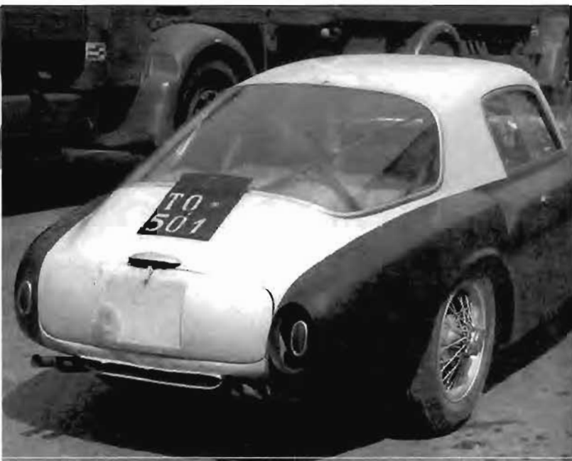
Sopra, la coda spiovente della berlinetta Lancia D20 era in linea con le GT italiane dell'epoca. Particolare invece lo sfogo dell'aria attorno al fanale posteriore destro, che serviva al raffreddamento del radiatore dell'olio. A destra, particolare del parafrangente posteriore destro con la presa d'aria per il radiatore dell'olio.
