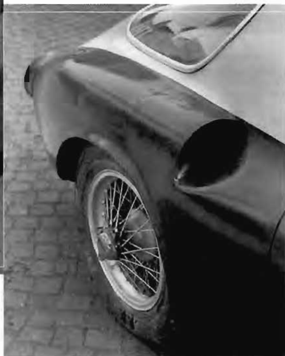
Sopra, la coda spiovente della berlinetta Lancia D20 era in linea con le GT italiane dell'epoca. Particolare invece lo sfogo dell'aria attorno al fanale posteriore destro, che serviva al raffreddamento del radiatore dell'olio. A destra, particolare del parafrangente posteriore destro con la presa d'aria per il radiatore dell'olio.
