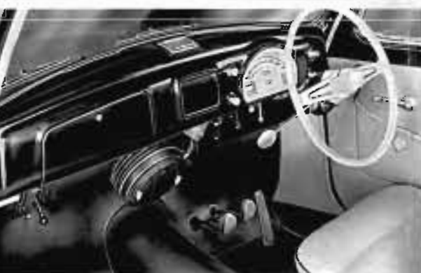
A sinistra, la plancia era molto elegante per l'epoca. Alcuni comandi erano nascosti alla vista per dare maggiore linearità al cruscotto. Il volante, il pomello del cambio e il quadro porta strumenti erano di un delicato colore chiaro. Sopra, la Lancia Appia di Edilberto Mandelli in un controllo orario del Rally Marconi il 25 aprile 1954.
