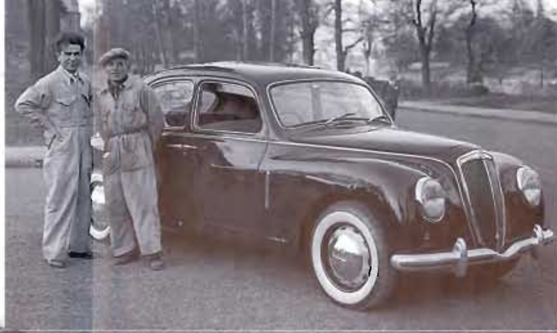
A sinistra, uno dei primi modelli della Lancia Aurelia B10 ancora dotati degli indicatori a freccia, poi sostituiti dai lampeggiatori. La coda è spiovente, con il volume del baule appena accennato.
