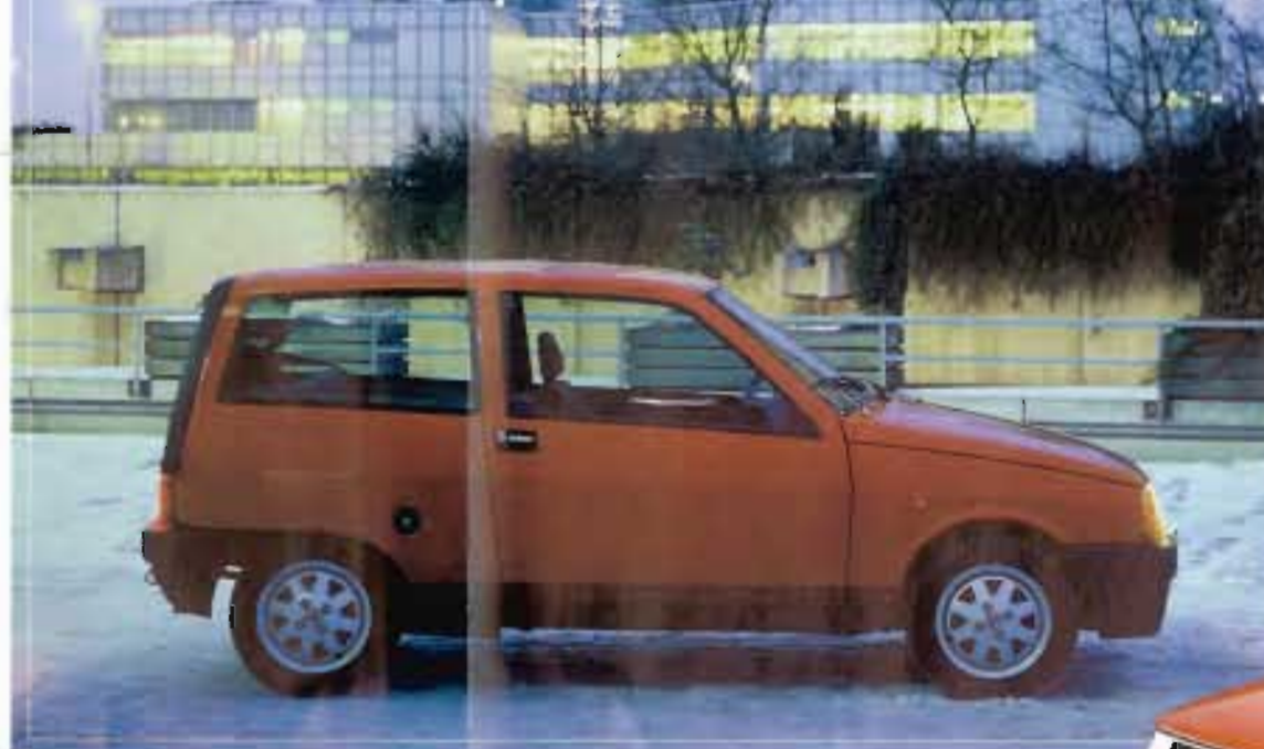
A sinistra, la forma a sviluppo cuneiforme della Autobianchi Y10, con il frontale "morbido" e la coda che chiude bruscamente, è chiaramente visibile nella versione Touring del 1985. Sotto, il portellone della Autobianchi Y10 era nero opaco con qualsiasi colore della carrozzeria. Fu anche un'esigenza costruttiva derivante dalla diversa resa delle vernici sulla lamiera e sulla plastica.
