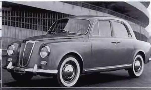
*Sopra, la Lancia Appia elaborata da Zagato sulla carrozzeria della berlina di serie. I principali interventi riguardarono l'abbassamento della linea del cofano anteriore, l'innalzamento delle creste dei parafranghi posteriori e la verniciatura con una tinta metallizzata extra serie. A sinistra, la seconda evoluzione della Appia carrozzata da Zagato nella versione GT destinata all'uso sportivo. Questo esemplare con Sergio Mantovani alla guida si impose nella sua classe nella Mille Miglia.*
