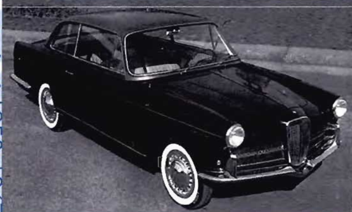
Sotto, a sinistra, una spaziosa coupé a 4 posti proposta da Vignale nel 1956 sull'autotelaio della Lancia Appia. Il padiglione luminoso e ben impostato anticipa quello della Appia Lusso che poi il carrozziere produsse in serie per conto della Lancia.
