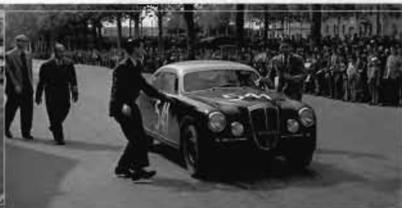
A sinistra, 26 aprile 1953, posto di controllo di Firenze. Il pilota si ristora con una bibita mentre un meccanico controlla la piccola 750 Sport marca ALF (Avalle-Lancia-Fiorio) dotata di un motore Lancia Ardea ridotto nella cilindrata da Mario Avalle e Alessandro Fiorio. A destra, la 750 Sport di Adanti/Vinci poco prima del ritiro. La vetturetta fu costruita da Alessandro Vinci con un motore Lancia Ardea ridotto a 750 cc da Aldo Faccioli, un telaio Fiat Topolino modificato da Mimmo Benelli e una carrozzeria realizzata da Fernando Ortolani.
