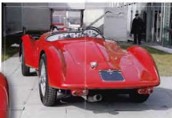
Sopra, la coda affilata e sottile della Lancia Astura Mille Miglia Sport. Il cofano è più basso delle creste dei parafranghi, il bocchettone del carburante ha l'apertura rapida tipica delle auto da corsa.
