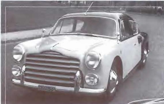
*A sinistra, il prototipo A10 con la guida centrale e il motore posteriore che Gianni Lancia fece vestire da Ghia per uso personale.*
