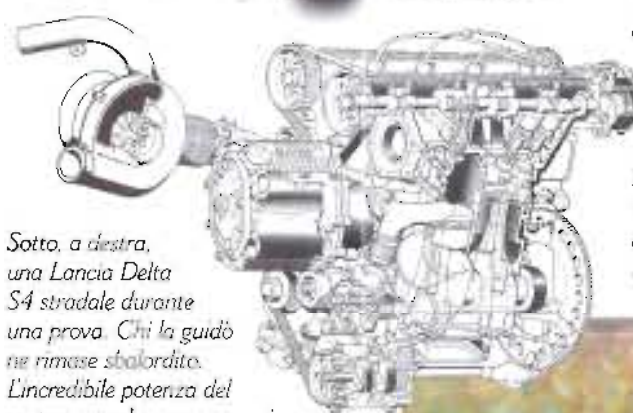
Sotto, vista in trasparenza del motore con 4 cilindri, 16 valvole e doppia sovralimentazione. All'estrema sinistra si distinguono chiaramente il compressore volumetrico a lobi e la turbina KKK.
