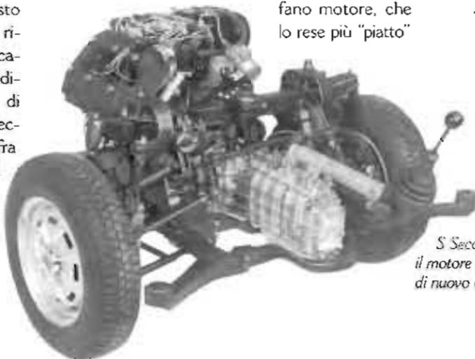
A sinistra, Il gruppo motopropulsore della Lancia Fulvia Coupé 1,3 S Seconda serie come di consueto ancorato a un telaio supplementare. Il motore è inclinato di 45° a sinistra. Si notano i cerchi di nuovo disegno e la leva del cambio corta con torretta di rinvio.
