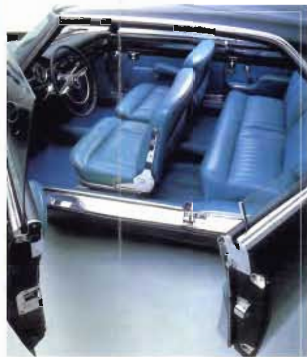
Sopra, la Lancia Flaminia Florida II con le quattro porte aperte. Con le porte chiuse le posteriori sono in pratica invisibili perché prive di maniglie esterne e dotate di battute eseguite con estrema precisione. A destra, l'abitacolo della Lancia Flaminia Florida II appare spazioso e rifinito con superba cura.
