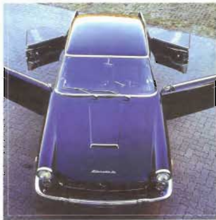
Sopra, la Lancia Flaminia Florida II con le quattro porte aperte. Con le porte chiuse le posteriori sono in pratica invisibili perché prive di maniglie esterne e dotate di battute eseguite con estrema precisione. A destra, l'abitacolo della Lancia Flaminia Florida II appare spazioso e rifinito con superba cura.
