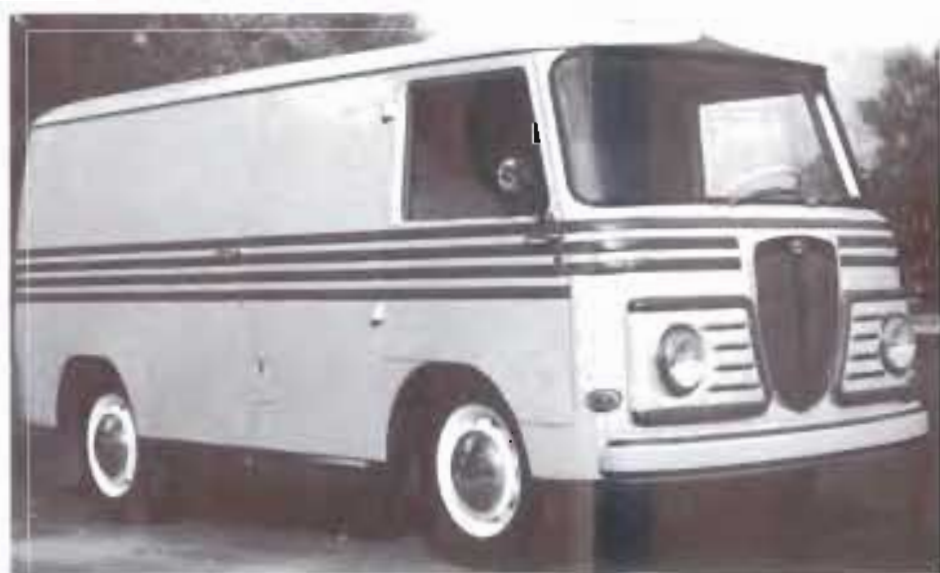
Sotto, il furgone Lancia Jolly con il motore derivato dall'Appia Terza serie e la scocca tutta nuova progettata per massimizzare le capacità di carico. L'esemplare raffigurato fu allestito dalla carrozzeria Viberti con alcune varianti rispetto all'originale.
