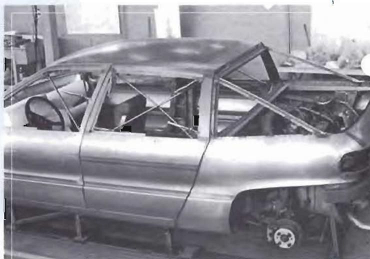
*A destra, la Lancia Medusa in costruzione. Si nota chiaramente la disposizione posteriore del propulsore, che è quello della Lancia Beta Montecarlo.*
