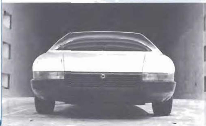
*A sinistra, il modello della Lancia Medusa visto di fronte nella galleria del vento. I primi test indicarono un CX (coefficiente adimensionale di forma) pari a 0,255.*
