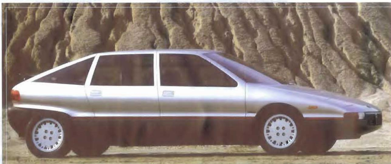
La versione finale della Lancia Medusa vista di lato. Trattandosi di un prototipo pronto per circolare aveva le segnalazioni luminose a norma. Il dispositivo di apertura e chiusura dei fari era stato parte integrante del progetto.
