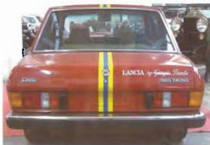
Sopra, la Lancia Trevi Volumex bimotores vista da dietro. La scritta "Lancia by Giorgio Pianta" non lascia dubbi sulla paternità del progetto. A destra, la Lancia Trevi Volumex bimotores vista di lato. Si notano i cerchi speciali con pneumatici da corsa, e le "orecchie" delle prese d'aria a metà della porta dietro e sul montante posteriore.
