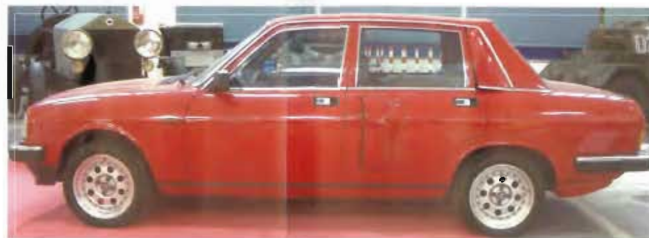
Sopra, la Lancia Trevi Volumex bimotores vista da dietro. La scritta "Lancia by Giorgio Pianta" non lascia dubbi sulla paternità del progetto. A destra, la Lancia Trevi Volumex bimotores vista di lato. Si notano i cerchi speciali con pneumatici da corsa, e le "orecchie" delle prese d'aria a metà della porta dietro e sul montante posteriore.
