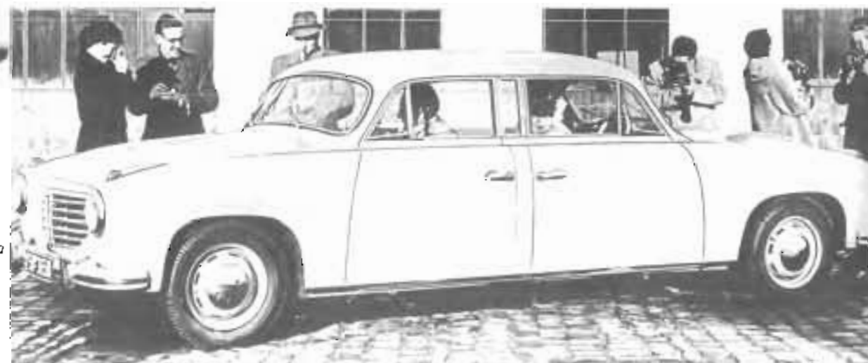
Sotto, la Goliath bimotore-bifronte che Carl F.W. Borgward presentò per burla il 1° aprile 1955. Realizzata con due tronchi anteriori di berline GP 700, era meno astrusa di quanto sembra. La soluzione fu ripresa per i veicoli anti-incendio operanti in zone dove è impossibile invertire rapidamente il senso di marcia.
