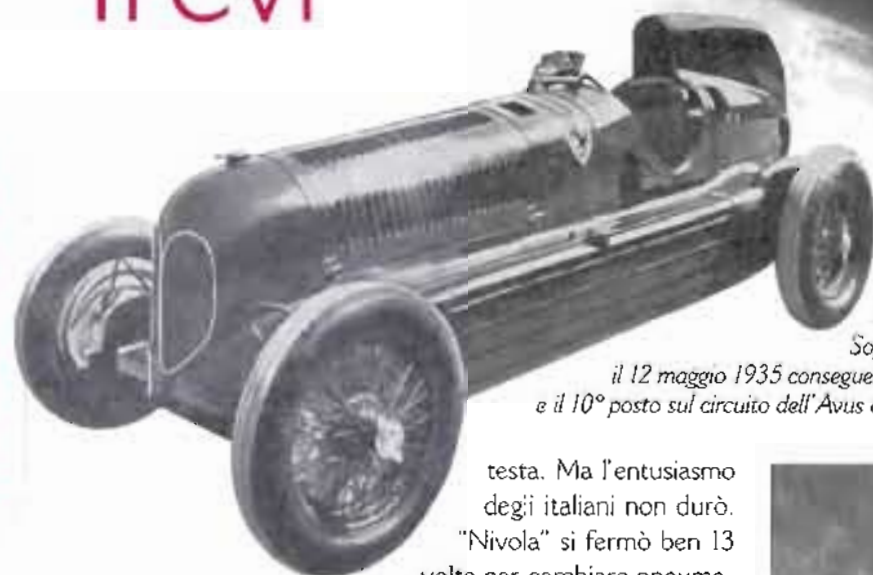
A sinistra, l'Alfa Romeo bimotore fu costruita in quattro mesi dalla Scuderia Ferrari a Modena con l'approvazione della Direzione della Casa nell'attesa dei nuovi modelli. Con due motori di 3165 cc ognuno disponeva complessivamente di 540 cv. Sopra, due esemplari debuttarono nel GP di Tripoli il 12 maggio 1935 conseguendo il 4° e il 5° posto. Il 26 maggio 1935 il 9° e il 10° posto sul circuito dell'Avus chiusero la carriera agonistica del modello.
